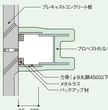
※バックアップ材:ロックウール保温板(100kg/m<sup>3</sup>以上)またはけい酸カルシウム板(200kg/m<sup>3</sup>以上)
