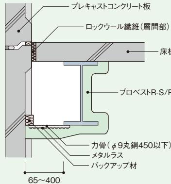
※バックアップ材:ロックウール保温板(100kg/m<sup>3</sup>以上)またはけい酸カルシウム板(200kg/m<sup>3</sup>以上)
