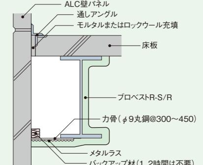
※バックアップ材:ロックウール保温板(100kg/m<sup>3</sup>以上)またはけい酸カルシウム板(200kg/m<sup>3</sup>以上)
