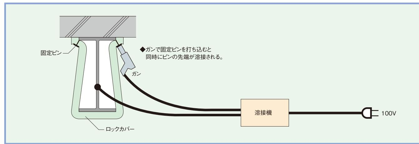
【注】1)下地にさび止め塗装が施されている場合やメッキ鋼板の場合には、ピンの溶接不良が生じる可能性がありますので、溶接後にピンの溶着具合を確認してください。
