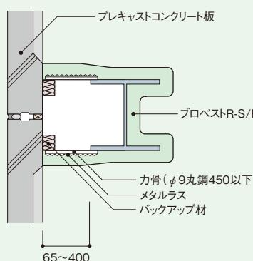
※バックアップ材:ロックウール保溫板(100kg/m<sup>3</sup>以上)またはけい酸カルシウム板(200kg/m<sup>3</sup>以上)
