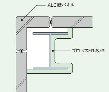
※バックアップ材:ロックウール保溫板(100kg/m<sup>3</sup>以上)またはけい酸カルシウム板(200kg/m<sup>3</sup>以上)
