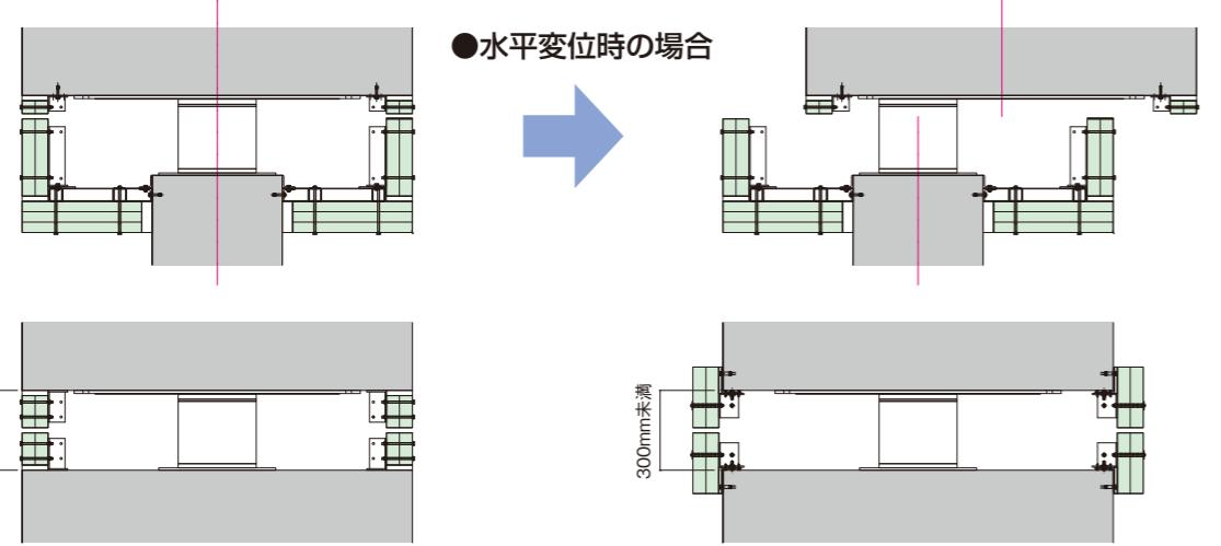
免震階の構造スリット用耐火目地材
