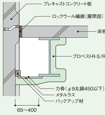
※バックアップ材:ロックウール保溫板(100kg/m<sup>3</sup>以上)またはけい酸カルシウム板(200kg/m<sup>3</sup>以上)
