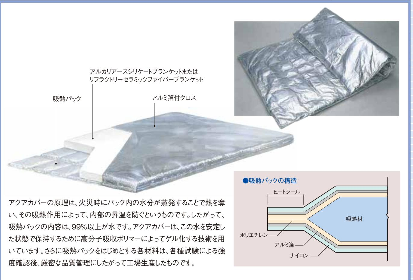
アクアカバーの原理は、火災時にパック内の水分が蒸発することで熱を奪い、その吸熱作用によって、内部の昇温を防ぐというものです。したがって、吸熱パックの内容は、99%以上が水です。アクアカバーは、この水を安定した状態で保持するために高分子吸水ポリマーによってゲル化する技術を用いています。さらに吸熱パックをはじめとする各材料は、各種試験による強度確認後、厳密な品質管理にしたがって工場生産したものです。
