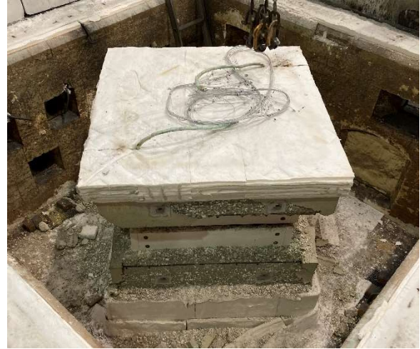
写真2 加熱試験後の試験体状況
